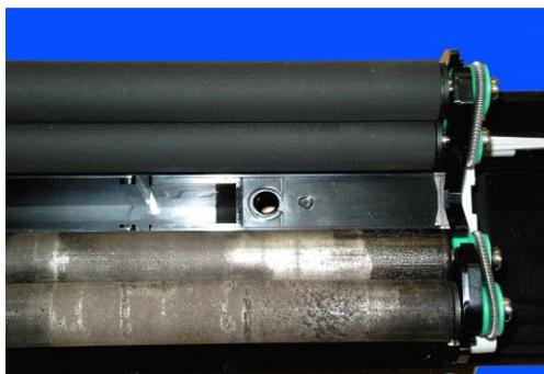
クロスオーバーラックは定期的な洗浄が必要です。特に発色現像液が触れるP1・P2のローラは薬品のタール状成分（現像液の酸化物）が付着し、ローラ（ユニット）本来の機能を低下させる原因のひとつとなります。
